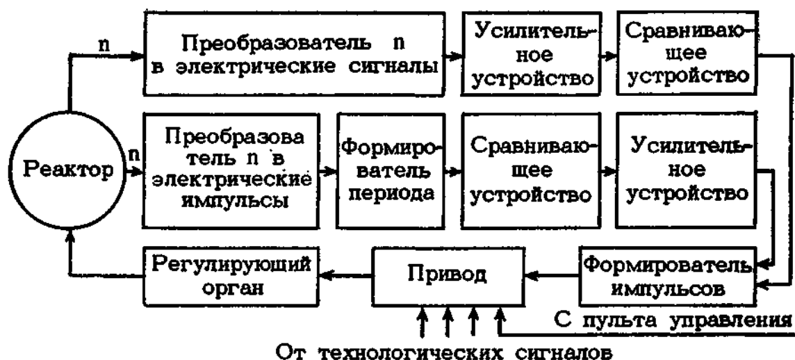
Рис. 1.3. Схема аварийной защиты реактора
